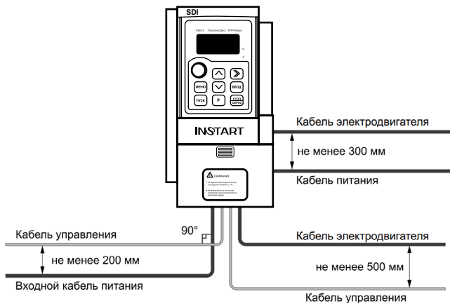
Рис. 3.6 - Графическое представление расстояний между кабелями
