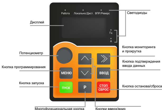
Рис. 5.1 - Функции кнопок и светодиодов панели управления SDI
