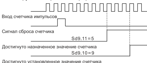
Рис. 6.23 - Работа функции счетчика импульсов
